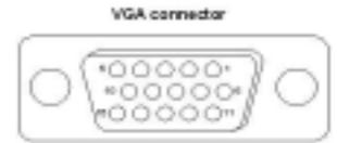
Die VGA – Schnittstelle wird zur Übertragung des Videosignals zwischen Grafikkarte und dem Monitor verwendet.
