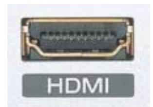
Um den Anforderungen der Unterhaltungselektronik-Industrie gerecht zu werden, wurde speziell die HDMI-Schnittstelle entwickelt. Das dafür vorgesehene Anschlusskabel hat einen 19-poligen Stecker und überträgt Videodaten, Audiodaten mit Frequenzen von bis zu 192 kHz und CEC (Consumer Electronics Control) und AV.
