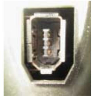
Die Übertragungsrates sind mit bis zu 800Mbits/s fast doppelt so schnell wie das USB 2.0. mit dieser Übertragungsgeschwindigkeit ist i.LINK sogar schneller als Ultra Wide SCSI und kann somit auch für Externe Festplatten genutzt werden.
